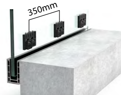
5. Paigalda reguleeritavad klotsid ja loodi klaas, kinnita reguleerkruid.
